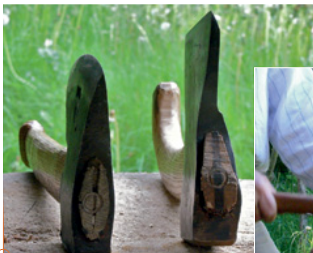
Ungleiche Geschwister: Links das Universalwerkzeug, ein normales zweiballiges Schnitzbeil mit gerundeter Fase, rechts ein kleines Breitbeil. Das Breitbeil mit Spiegel und gerade, scharf abgesetzter Fase, schneidet aggressiv geradeaus.
