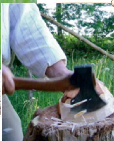
Der Stiel ist ganz bezahlt ... Um an diesem Schalenrohling möglichst schnell viel Masse zu entfernen, wird der Stiel so lang wie möglich gefasst – gute Beilarbeit spart viel Zeit an der Drechselbank. Kürzer gehalten kann mit dem Schnitzbeil die Rundung fast auf halben Riss gehauen werden.
